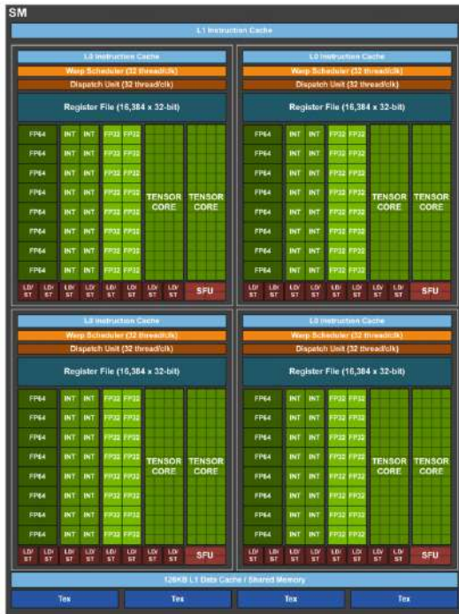
FIGURE 1.5 – Architecture des cartes Nvidia Volta V100. Organisation des différents cœurs de calcul et niveaux de mémoire au sein d'un multi-processeur. (source: Nvidia – http://images.nvidia.com/content/volta-architecture/pdf/volta-architecture-whitepaper.pdf ).
